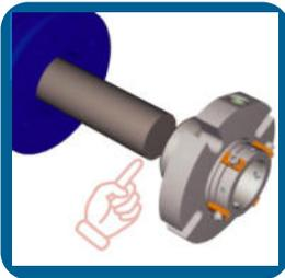
**1** Lubrique el oring interno de la camisa del sello con grasa a base de silicona (incluida) antes de instalarlo en el eje. Verifique la ubicación del oring en la brida (utilice grasa para sostenerlo si es necesario).
