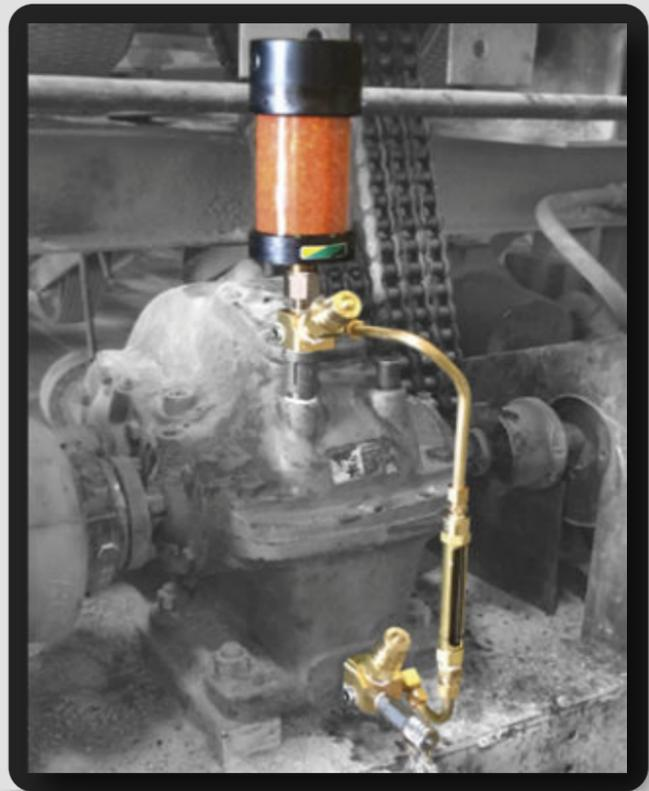
Proteja la integridad de sus lubricantes en servicio con el kit de instalación para cajas de engranajes.
