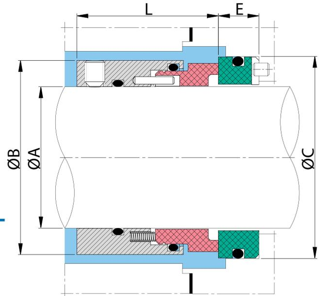
Sello mecánico de gran capacidad autoalineante y de alta confiabilidad para el sellado de servicios en general, ideal para solventes, bombas alimentadoras de calderas, condensados, etc.
