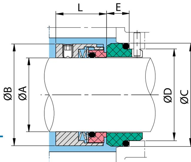
Sello mecánico no balanceado para aplicaciones generales, de gran estabilidad y alineación entre caras. Facilita el trabajo con fluidos abrasivos, pastas y otros con tendencia a solidificarse.
