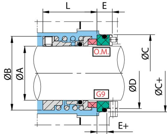
El Sello 500AL es ideal para trabajo pesado en medios muy abrasivos. Ideal para manejo de pastas y productos con tendencia a solidificarse o a pegar las caras. El sistema de transmisión de torque resiste a los arranques en frío y a los cambios de dirección de la bomba.
