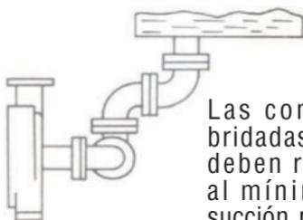
Las conexiones bridadas y codos deben reducirse al mínimo en la succión para evitar turbulencias.
