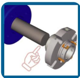
**1** Lubrique el oring interno de la camisa del sello con grasa a base de silicona (incluida) antes de instalarlo en el eje. Verifique la ubicación del oring en la brida (utilice grasa para sostenerlo si es necesario).
