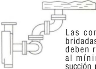
Las conexiones bridadas y codos deben reducirse al mínimo en la succión para evitar turbulencias.
