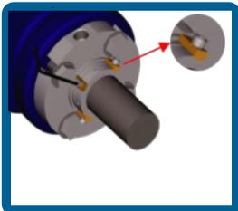
**7** Suelte los posicionadores o calzas en bronce y guárdelos. Estos deben quedar disponibles para posterior uso en el desmontaje y montaje del sello mecánico.
