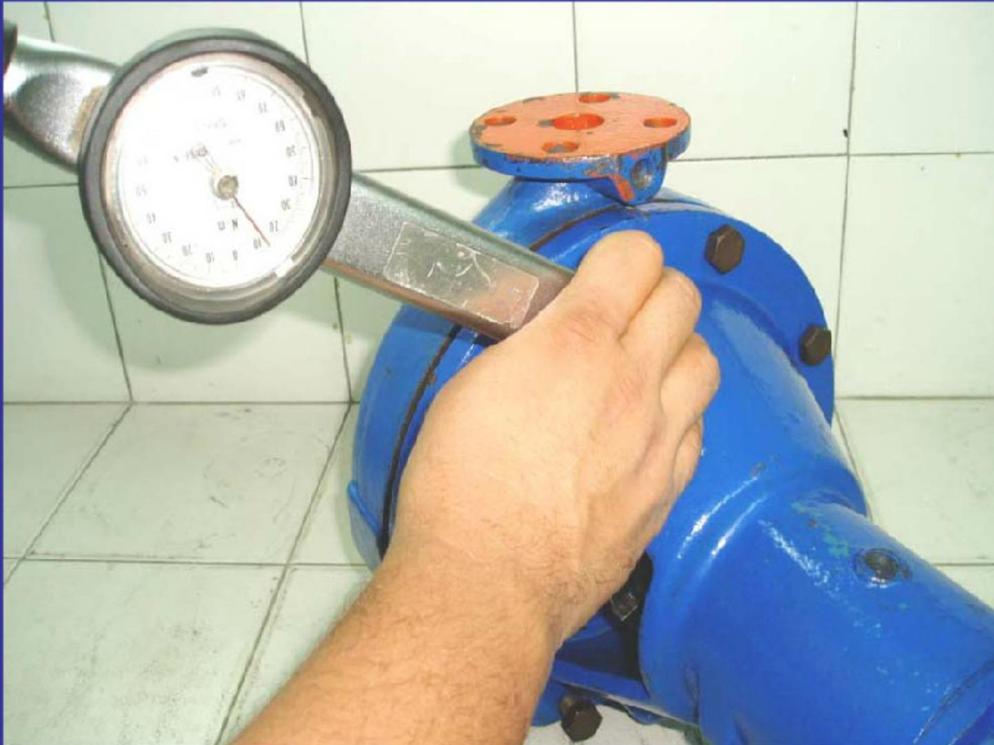
Ajuste el estopero con la llave de torque, para garantizar perpendicularidad de la voluta con el cuerpo de la bomba
