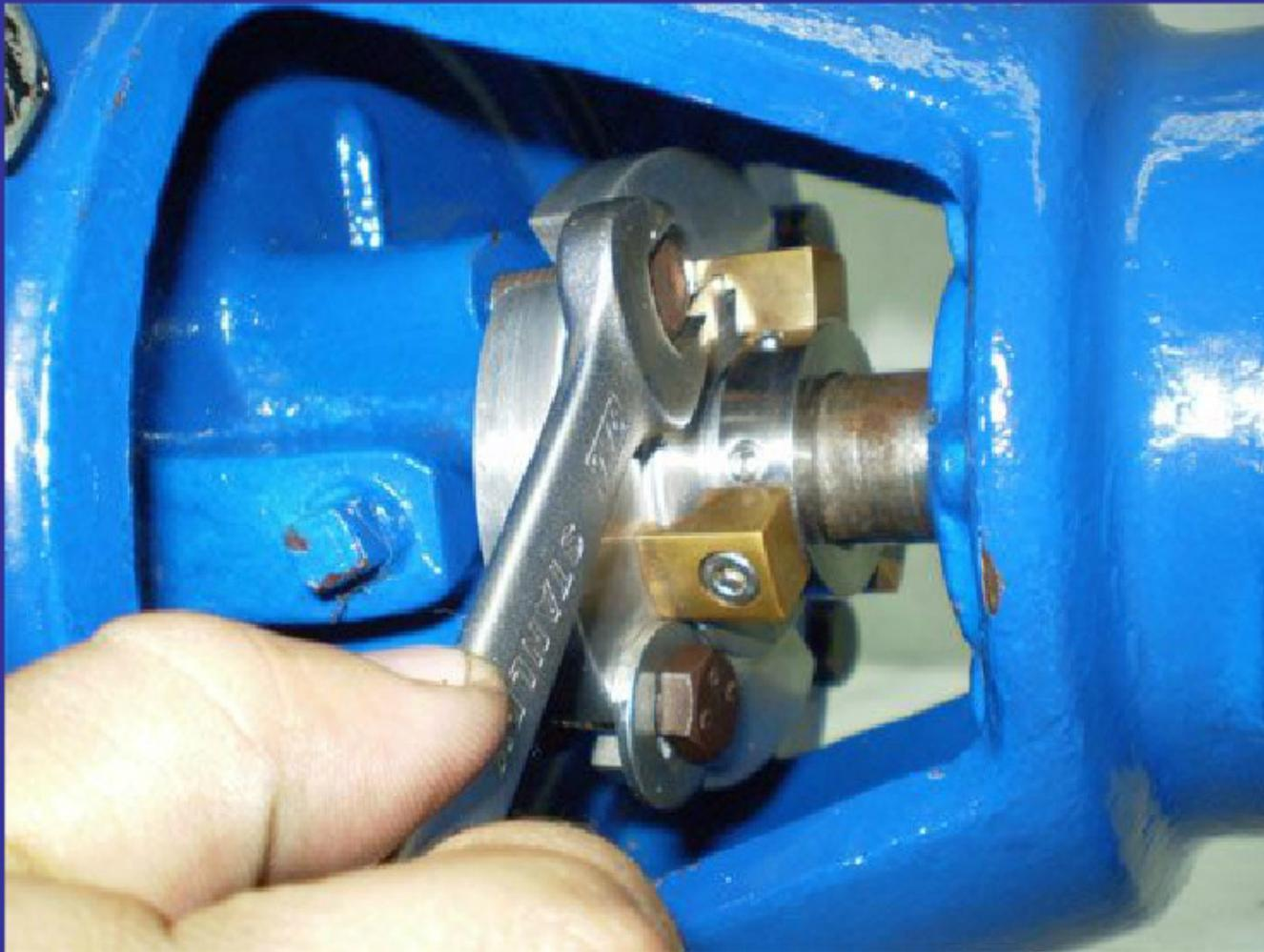
Fije la brida a la bomba ajustando uniformemente los pernos para garantizar paralelismo con la cara de la bomba.
