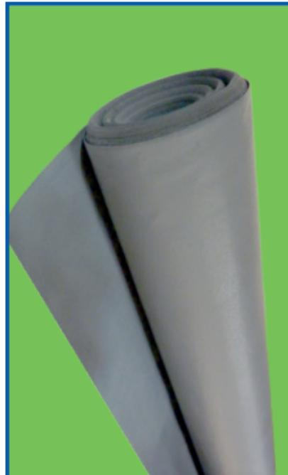
**DESCRIPCIÓN:** La tela de fibra de vidrio tejido plano se somete a un proceso de coextrusión laminación con PTFE en las dos caras para conformar una tela antiadherente químicamente inerte resistente a la mayoría de productos químicos excepto a los alcalinos derretidos.
