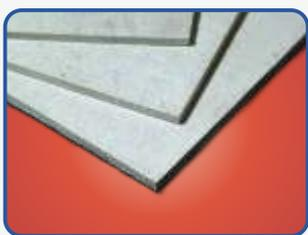
**DESCRIPCIÓN:** Las tablas SEALAM tejidas son materiales refractarios ligeros producidos a base de fibra de asbesto y no asbesto aglutinadas con material silicoaluminoso, empleadas en aplicaciones hasta 400°C en su presentación base asbesto y hasta 800°C base no asbesto. Se caracterizan por ser excelentes aislantes térmicos de fácil maquinabilidad diseñado especialmente para soportar flujo de gases a alta velocidad.
