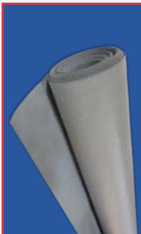
**DESCRIPCIÓN:** La tela de fibra de vidrio tejida plano se somete a un proceso de coextrusión laminación con PTFE en las dos caras para conformar una tela antiadherente químicamente inerte resistente a la mayoría de productos químicos excepto a los alcalinos derretidos.
