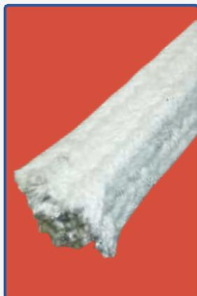
**DESCRIPCIÓN:** Hilos de fibra cerámica reforzados con inserción metálica, son utilizados para fabricar esta empaquetadura en estilo multitrenzado, las cuales le permiten ofrecer gran resistencia térmica, mecánica y estabilidad dimensional con una alta capacidad de aislamiento.
