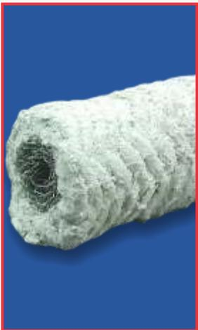
**DESCRIPCIÓN:** Sobre una alma trenzada de acero inoxidable 304 se trenzan capas utilizando hilos de asbesto para obtener un conjunto flexible que a pesar de las altas temperaturas mantiene su resiliencia, sin deformarse, obteniéndose el aislamiento requerido.
