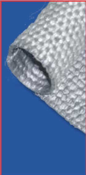
**DESCRIPCIÓN:** Tela 100% fibra de vidrio es recubierta con caucho de silicona en una cara (también por ambos lados a solicitud del cliente) para darle flexibilidad e impermeabilidad a los líquidos y resistencia al desgaste, por lo tanto es una excelente selección para cortinas de cuartos de soldaduras o simplemente para proteger equipos de calor.
