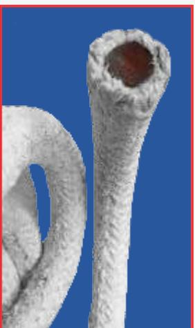
**DESCRIPCIÓN:** Se fabrica trenzando hilos de asbesto grado A, sobre un alma de caucho para formar capas exteriores y obtener un alma con memoria.
