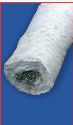
**DESCRIPCIÓN:** Sobre un alma trenzado de acero inoxidable 304 se trenzan capas utilizando hilos de fibra de vidrio conformando un conjunto flexible que a pesar de las altas temperaturas mantiene su resiliencia sin deformarse.
