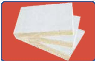
**DESCRIPCIÓN:** Placas cerámicas son rigidizadas y recubiertas con un cemento aislante moldeable que provee a la placa una superficie con mayor resistencia al fuego, mejores propiedades termomecánicas y una excelente apariencia física. Ideal para ser usada como aislante térmico en áreas donde se requieren altas temperaturas.
